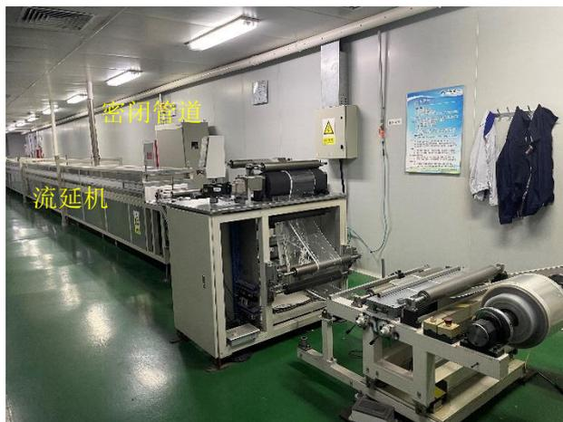
流延成型、坯片干燥工序
